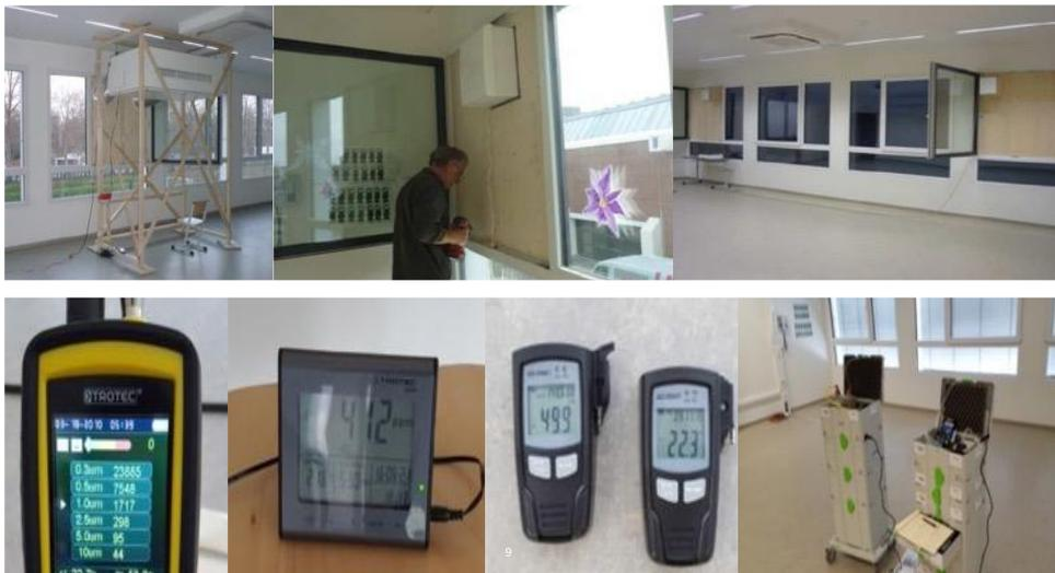
Abbildung 5: Test mit 3 unterschiedlich großen dezentralen Lüftungsanlagen im gleichen Klassenraum. Von links – Sensormessgeräte für Partikel, CO<sub>2</sub>, Feuchte/Temperatur, VOC Raumluftanalyse/Pumpenausrüstung.
