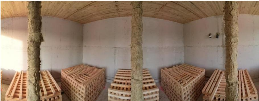
Bild 14: 180° Drohnenaufnahme aus dem Inneren des Brandraumes (V1)
