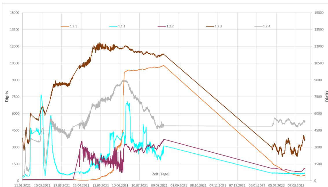
Abbildung 12: Erdgeschoss - Bandsensoren 1.1.1 auf der Stahlbetondecke montiert; 1.2.1 – 1.2.3 auf Bitumenbahnen montiert; 1.2.4 auf einer Kunststoffbahn – Dampfsperre montiert
