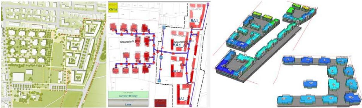
Abbildung 12: Simulationsmodell eines Wohnquartiers einschließlich Wärmenetz.
