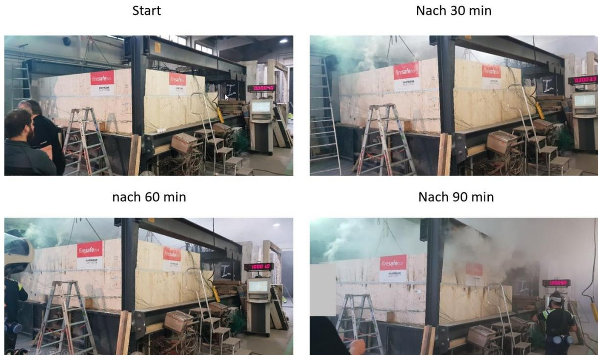
Abbildung 8: Momentaufnahmen des Brandversuchs beim Start und nach 30, 60 und 90 Minuten Branddauer (Quelle: Kaufmann Bausysteme)
