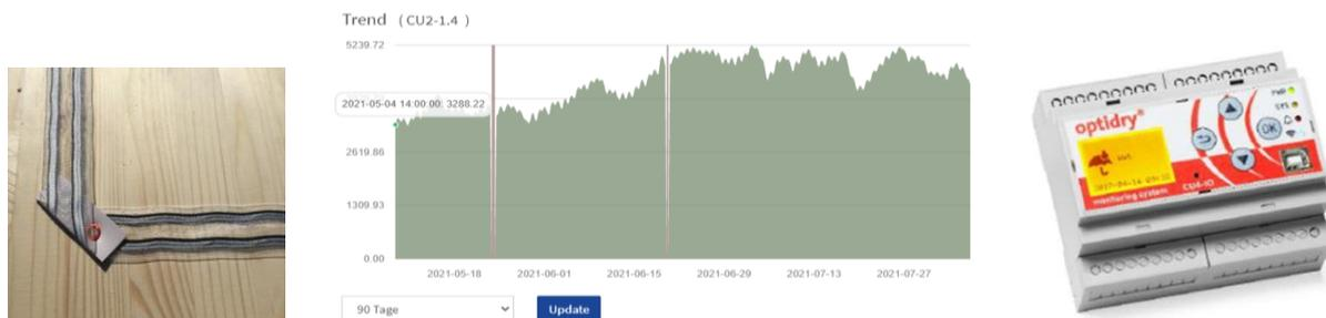
Abbildung 2: Optidry Monitoring-System (OMS); Feuchte- und Dichtheitsmessung mittels Bandsensoren
