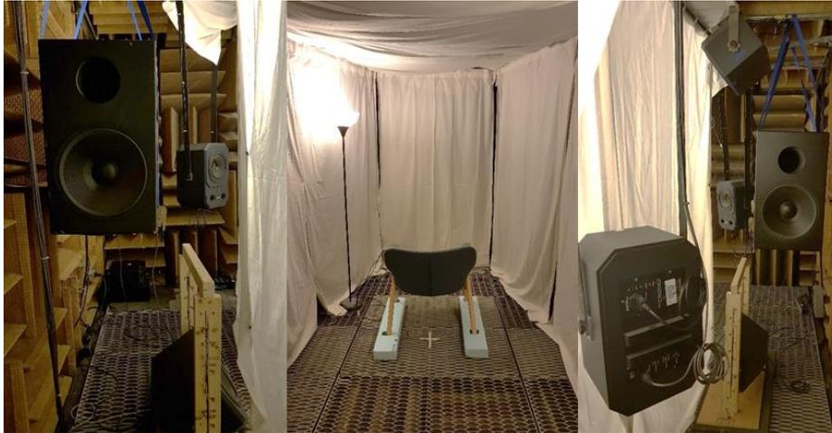
Abbildung 10: Lautsprecheraufbau für den Hörversuch
