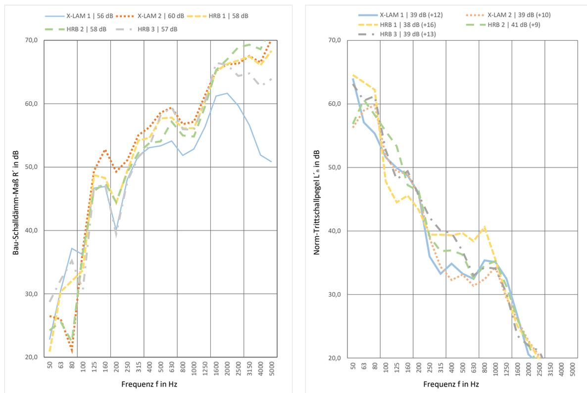
Abbildung 9: Varianten Moduldeckel, Bodenaufbau Trockenestrich mit Schüttung,  $R'_w$  bzw.  $L'_{n,w}$  ( $C_{1,50-2500}$ )
