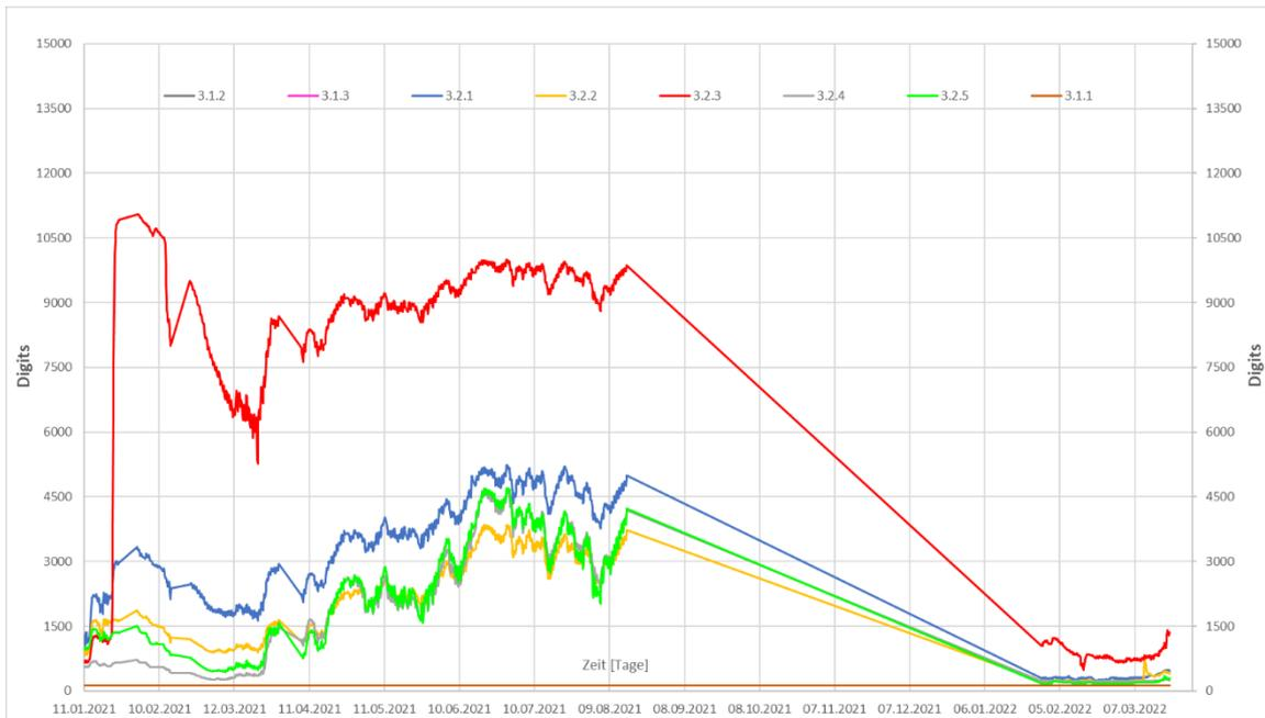
Abbildung 10: Flachdach- Bandsensoren 3.1.1 – 3.1.3 auf der Brettsperrholzdecke; Bandsensoren 3.2.1 – 3.2.5 auf der ersten Abdichtungsebene (Dampfsperre – Kunststoffbahn)
