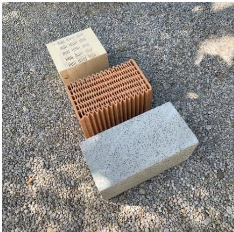
Abbildung 6: Die drei verwendeten Außenwandmaterialien: Massivholz und Ziegel – jeweils mit Luftkammern, sowie Infralichtbeton.
