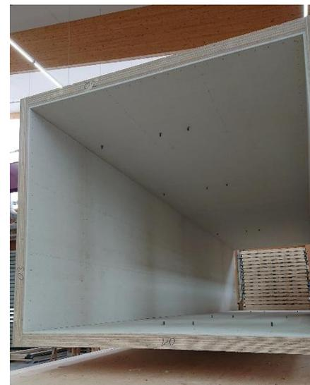
Abbildung 12 a und b: Aufzugschächte über 2 und 3 Geschosse
