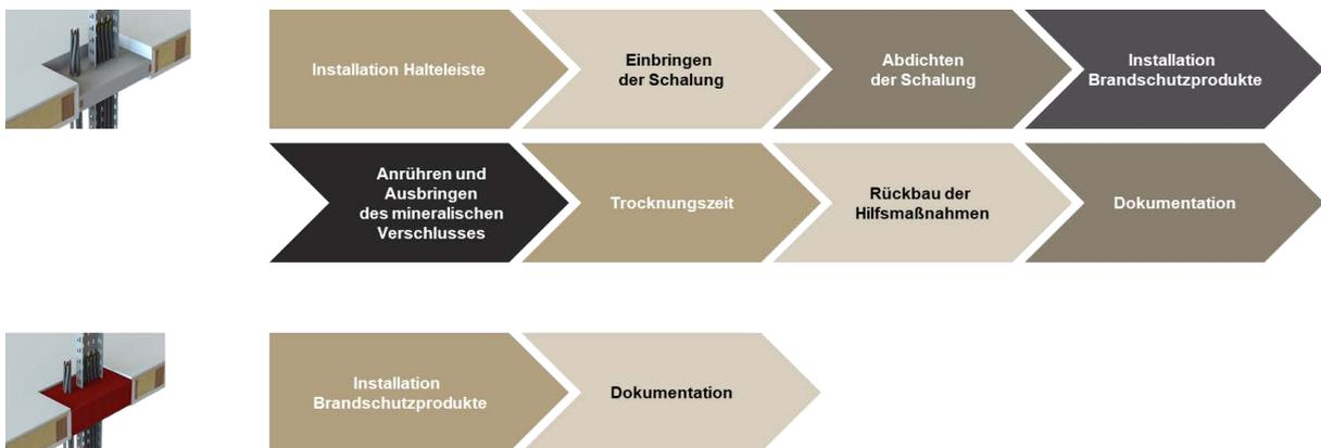
Abbildung 8: Gegenüberstellung der Arbeitsschritte bei mineralischem Verschluss und trockenen Brandschutzlösungen
