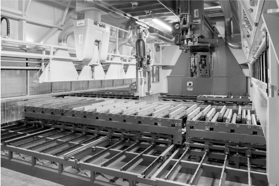
Abbildung 5: Produktionstechnologie, PBA-Anlage Hundegger, © ZÜBLIN Timber
