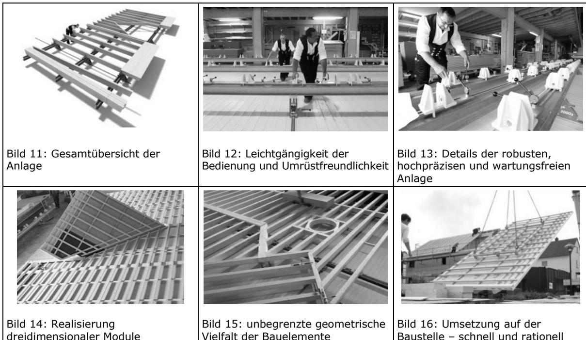
Die Bilder 11 bis 13 zeigen das Aufbauprinzip des Multifunktionstisches. Auf dem Hallenboden fixierte Flachsienen von ca. 20 mm dienen als Führungsschienen für den Rollwagen. Die auf den Längsträgern verstellbaren Spannelemente nehmen die tragenden Komponenten der Holzbauelemente auf.
