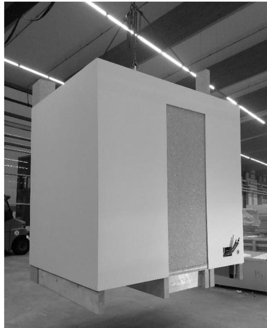
Abbildung 1: Prototyp Fertigbad
