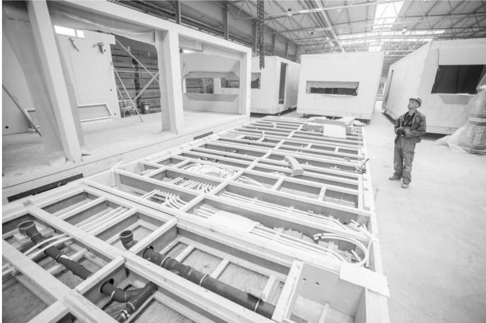
Abbildung 2: Am Montageplatz werden die Module zusammengebaut.
