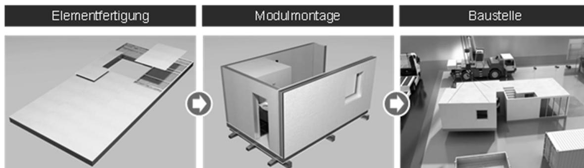
Abbildung 1: Produktionsprozess im modularen Hausbau
