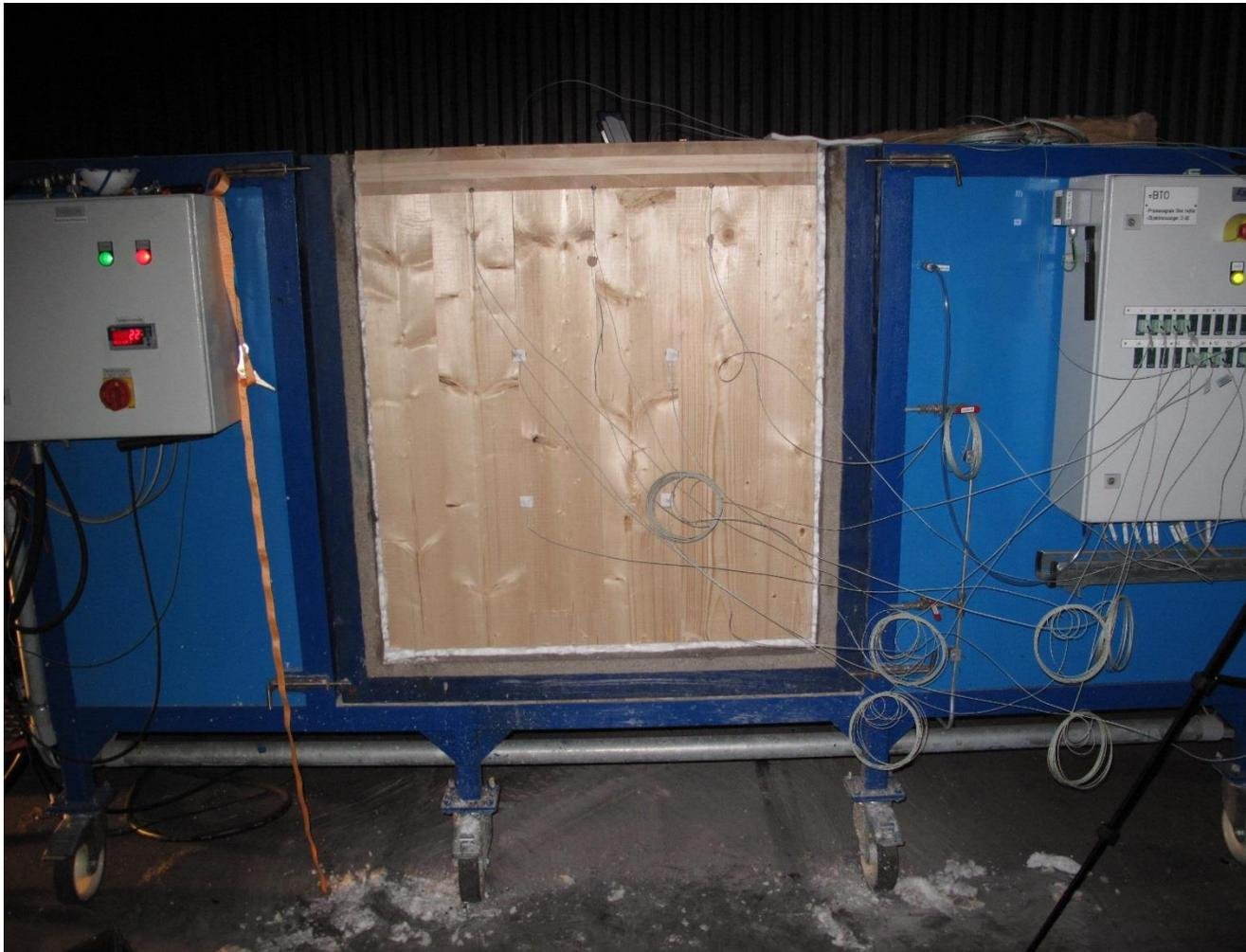
Kleinbrandversuch BSP/BSP am Institut für Brand- und Katastrophenschutz Heyrothsberge
