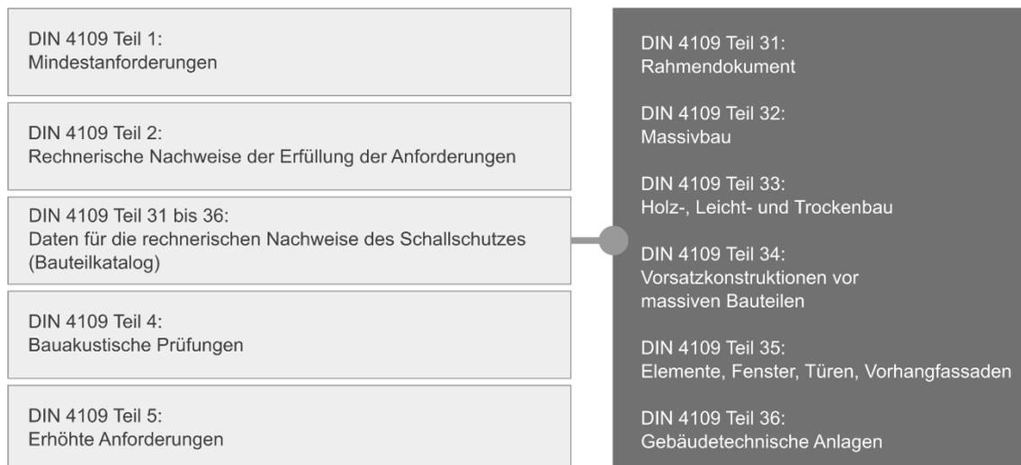
Abbildung 1: Struktur der neuen Schallschutznorm für den Hochbau DIN 4109:2018-01 bzw. 2020-08
