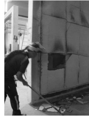
Abbildung 20: Öffnung der Beplankung – 6 Minuten nach Prüfeinde – WA1
