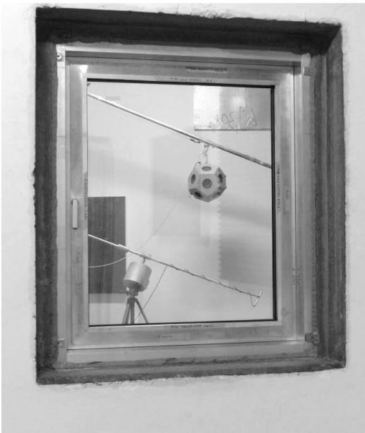
Abbildung 3: Beispiel für ein Einsetzelement in einem Fassadenrahmen im Normformat, eingebaut in den Fensterprüfstand nach DIN EN ISO 10140
