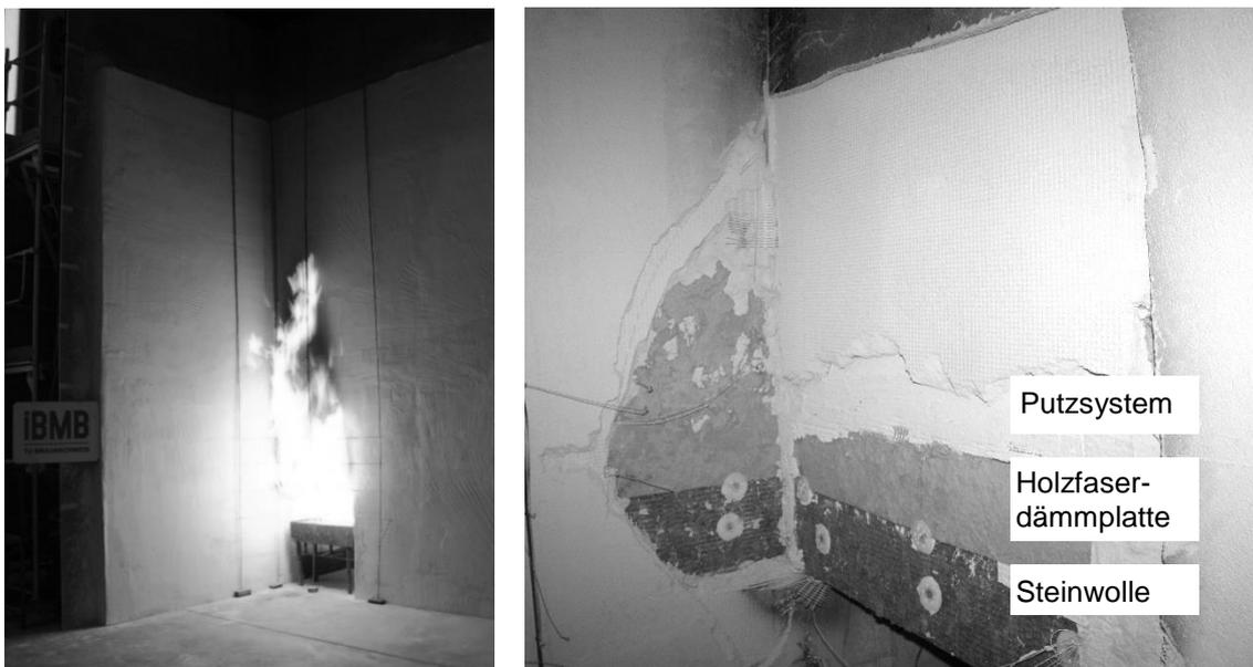
Abbildung 5: Holzfaser-WDVS während der Beflammung im Fassadenprüfstand (links); nach Versuchsende geöffnetes System mit ungeschädigtem Holzfaserdämmstoff im Bereich über der Brandraumöffnung (rechts)
