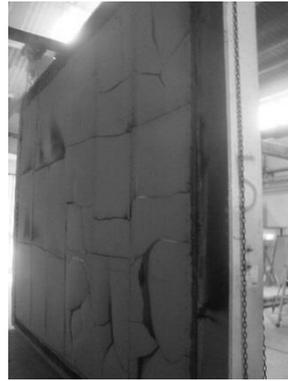
Abbildung 19: Unmittelbar nach Prüfeinde – große und viele Risse in Gipsfaserplatte – WA2
