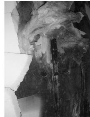
Abbildung 23: WA1 – fortschreitende Verkohlung bei einzelnen Stehern im Bereich Plattenstoß – 34 Minuten nach Prüfeinde
