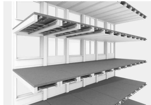
Abbildung 3: Achsmodule von Suprafloor EcoBoost
