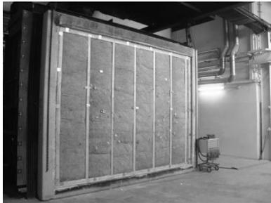
Abbildung 15: nach 47 Minuten beginnende Braunverfärbung bei Probekörperhälfte WA2
