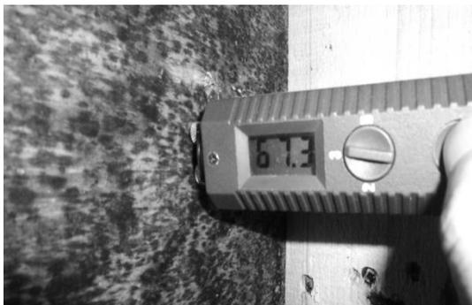
Abbildung 2: Kondensatfeuchte im DG
