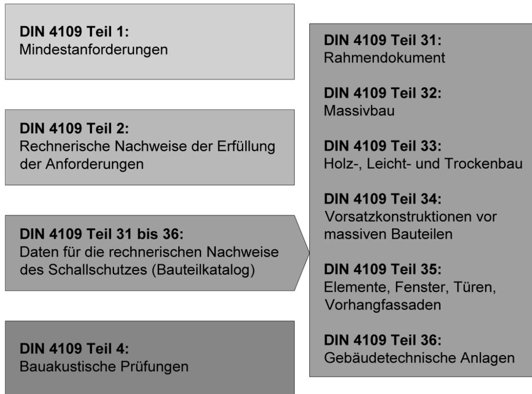
Abbildung 1: Struktur der neuen Schallschutznorm für den Hochbau DIN 4109:2018-01
