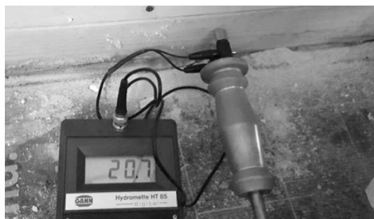
Abbildung 9: Schwellholz Feuchtemessung
