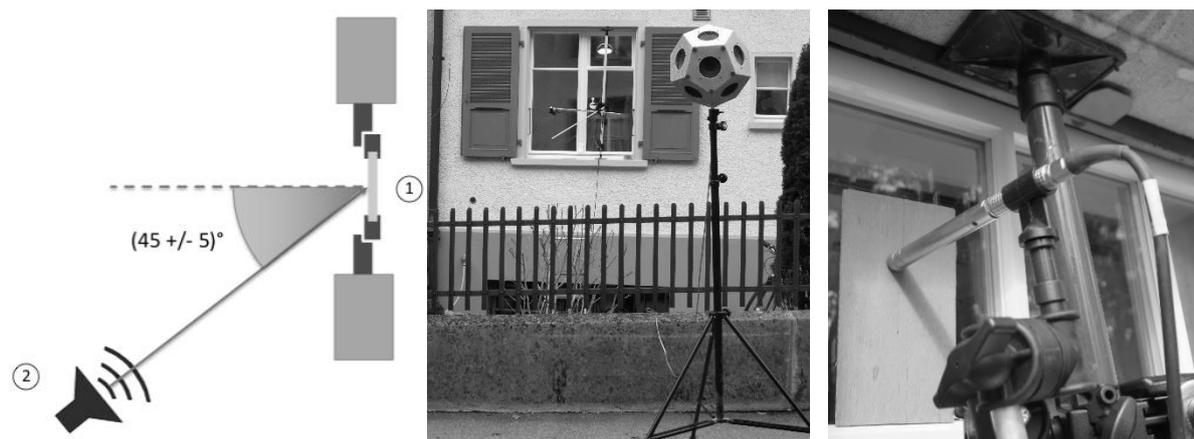
Abbildung 2: Links und Mitte: Messprinzip Bauteil-Lautsprecher-Verfahren nach EN ISO 16283-3 [5]; der Lautsprecher (2) wird außen so aufgestellt, dass die Schallwelle unter einem Winkel von  $(45 \pm 5)^\circ$  auf das Fenster (1) einfällt. Rechts: Positionierung des Mikrophons im Abstand von 3 mm außen vor der Verglasung mit Hilfe eines Abstandhalters.
