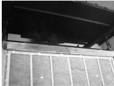
Abbildung 13: Nach 11 Minuten Rauchaustritt zwischen Probekörper und Prüfrahmen
