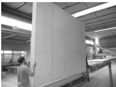
Abbildung 8: fertiges Element, 2. Lage Gipsfaserplatten
