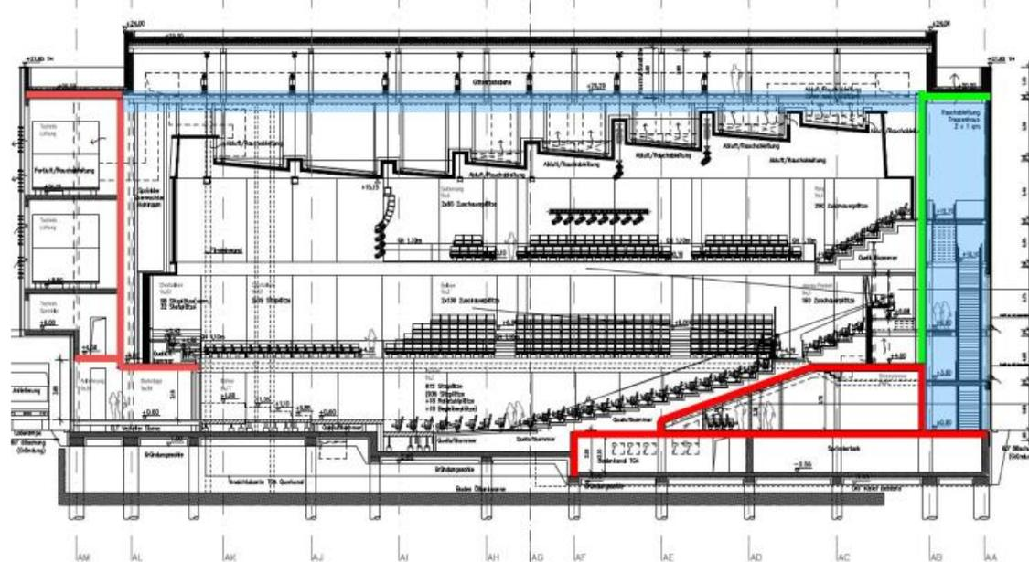
Abbildung der Bereichen mit Brandschutzanforderungen an dem Tragwerk:
