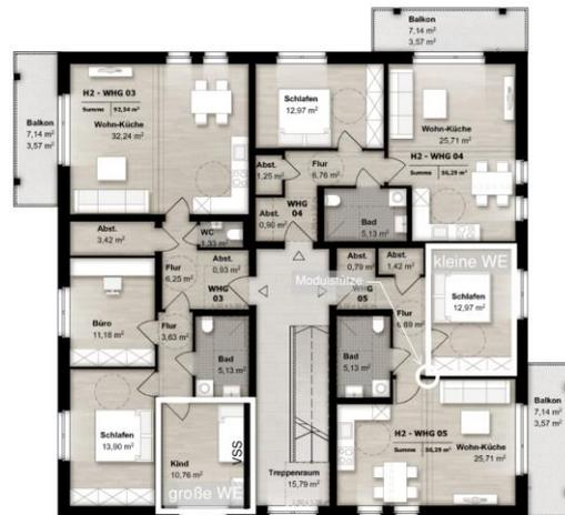
Abbildung 10: Grundriss Mehrfamilienhaus, Darstellung kleine und große Wohneinheit, dreigeschossig identisch
