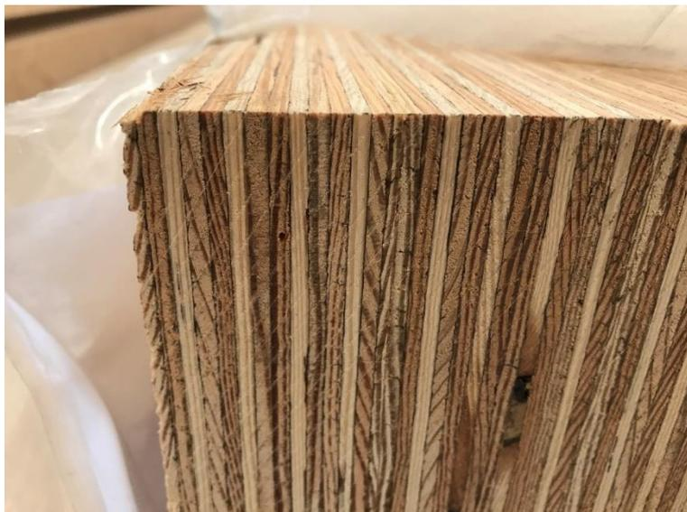
Abbildung 8: Furnierschichtholzträger, Gebr. Schütt KG (GmbH & Co.)
