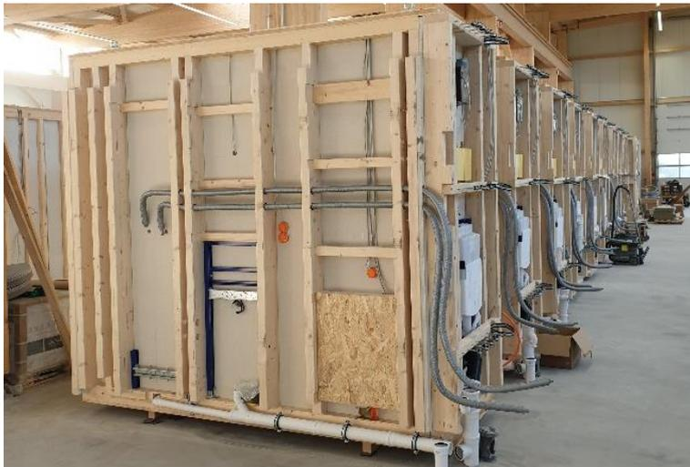
Abbildung 11: Badmodule in Vorproduktion, Gebr. Schütt KG (GmbH &amp; Co.)
