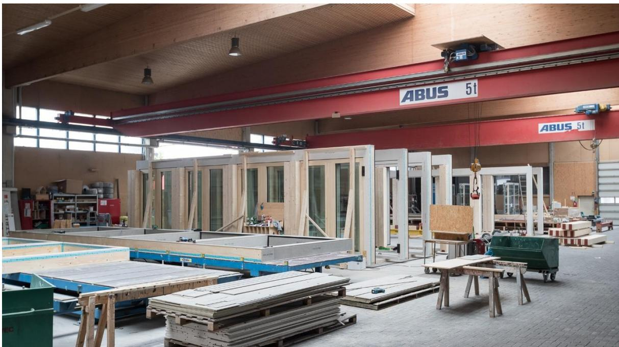
Abbildung 7: «Bürogebäude Handwerkerhaus» Bremen | Vorfertigung Außenwand | © CREE Deutschland GmbH
