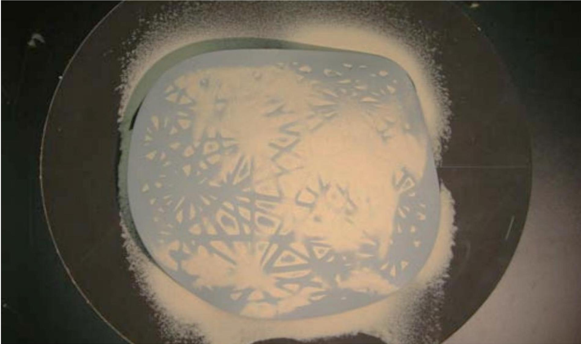
Windkanalversuch zur Ermittlung Windbelastung und von Schneeverfrachtungen (lokal bis zu  $160\text{kg/m}^2$ )
