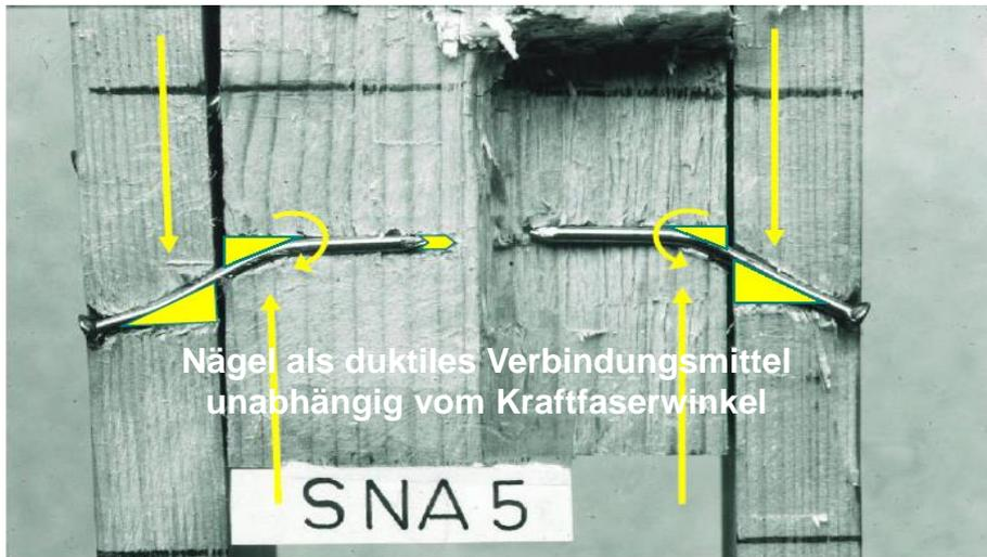
Nägel als duktile Verbindungsmittel unabhängig vom Kraftfaserwinkel
