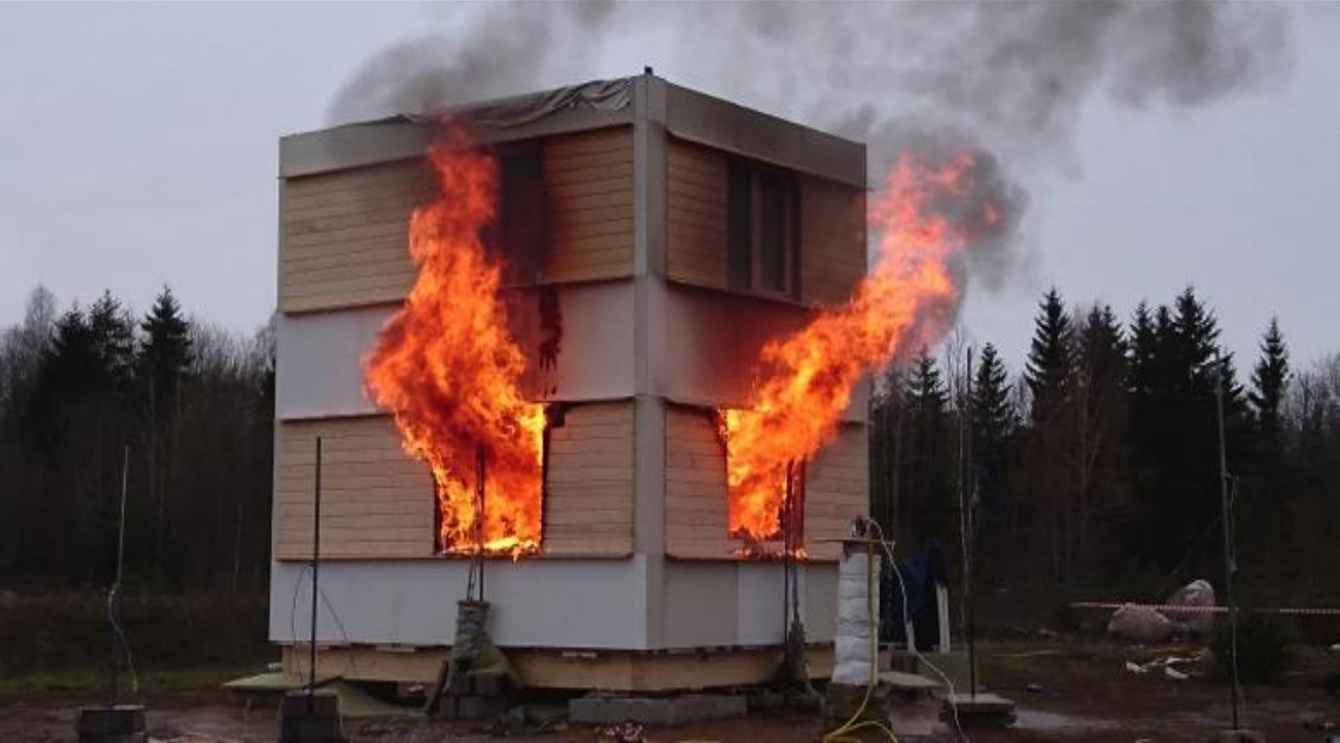
Ein Teil der Konstruktionen ist weiter durch nichtbrennbare, brandschutztechnisch wirksame Bekleidungen zu schützen!
